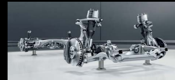
正確なハンドリングが堪能できる AMG RIDE CONTROL+エアサスペンション
