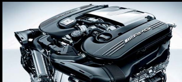
痺れるほどのハイパフォーマンスと高効率を実現する 4.0L V型8気筒直噴ツインターボエンジン(エンジン型式:177)
