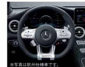
※写真は欧州仕様車です。 AMGパフォーマンスステアリング (ナッパレザー/DINAMICA)
