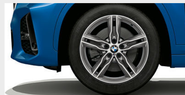
■ 18インチ M ライト・アロイ・ホイール・ダブルスポーク・スタイリング570M : 7.5J×18ホイール、225/50R18タイヤ (ランフラット・タイヤ)
